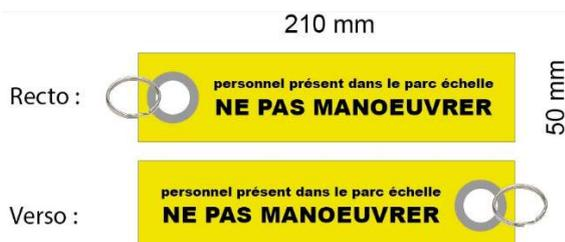
Ce dispositif de consignation se fixe aux commandes de l'échelle par un velcro double face.
